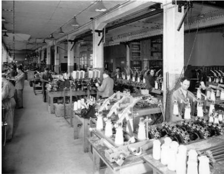
Atelier de montage d'interrupteurs "moyenne tension", 1948 (Collège du travail). L'isolant est en porcelaine.
